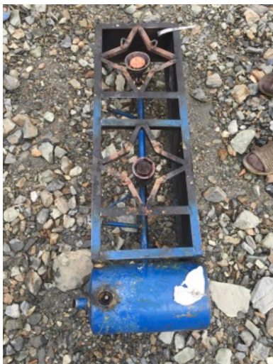
Der Benzin betriebene Küchenbrenner bekommt einen neuen Brenner spendiert. Die Zuleitung wird mit einer Art Teergemisch „abgedichtet“ und anschliessend auf seine Funktionalität geprüft. (Foto's by Michael Bärtschi)
