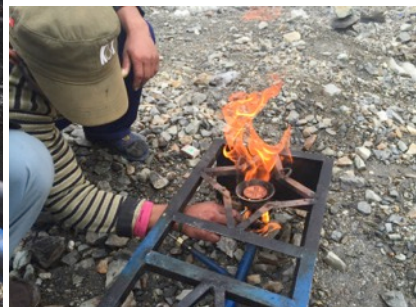
Der Benzin betriebene Küchenbrenner bekommt einen neuen Brenner spendiert. Die Zuleitung wird mit einer Art Teergemisch „abgedichtet“ und anschliessend auf seine Funktionalität geprüft. (Foto's by Michael Bärtschi)
