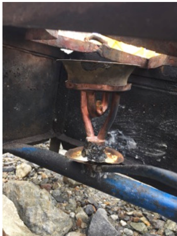
Der Benzin betriebene Küchenbrenner bekommt einen neuen Brenner spendiert. Die Zuleitung wird mit einer Art Teergemisch „abgedichtet“ und anschliessend auf seine Funktionalität geprüft. (Foto's by Michael Bärtschi)
